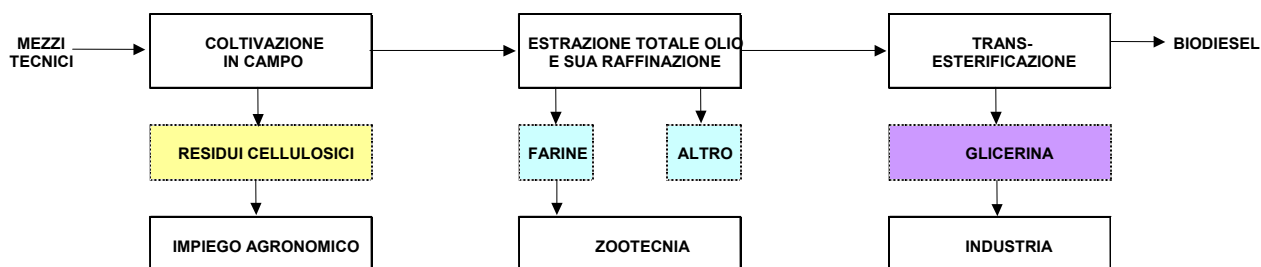
Figura 1. Attuale organizzazione della filiera del biodiesel e impiego prevalente dei sottoprodotti.
