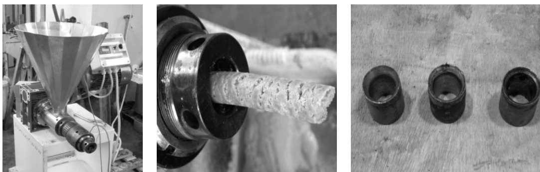
Fig.2 - La macchina spremitrice (sinistra), l'expeller (centro) e gli estrusori di diverso diametro (destra).
