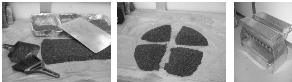
Figura 1 - I tre metodi utilizzati per la riduzione del campione: long pile (sinistra), coning&quartering (centro), riffle box (destra)
