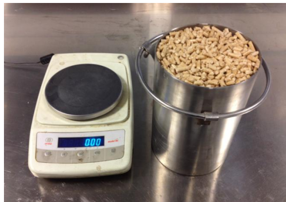
Sistema di misura della massa volumica utilizzato dal Laboratorio Biomasse
